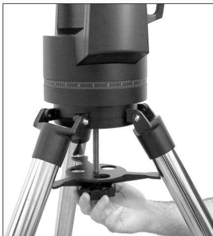
Fig. 4: Acoplamiento del telescopio al trípode. Observe la orientación de la barra de extensión.
