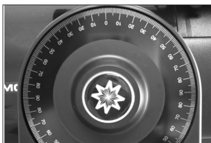
Fig. 28: Sección del círculo de ajuste de la declinación.
